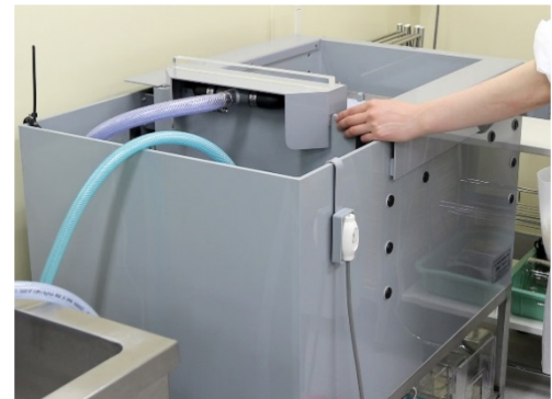
図 3 すきばめ機による修理
